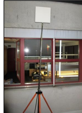
Abbildung 5: PLPO an Feuerwehrestativ befestigt
